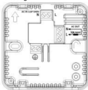
Branchez le courant alternatif sous tension et neutre (marqué AC IN 110-240v). Cette alimentation doit provenir de l'embranchement à fusible.
